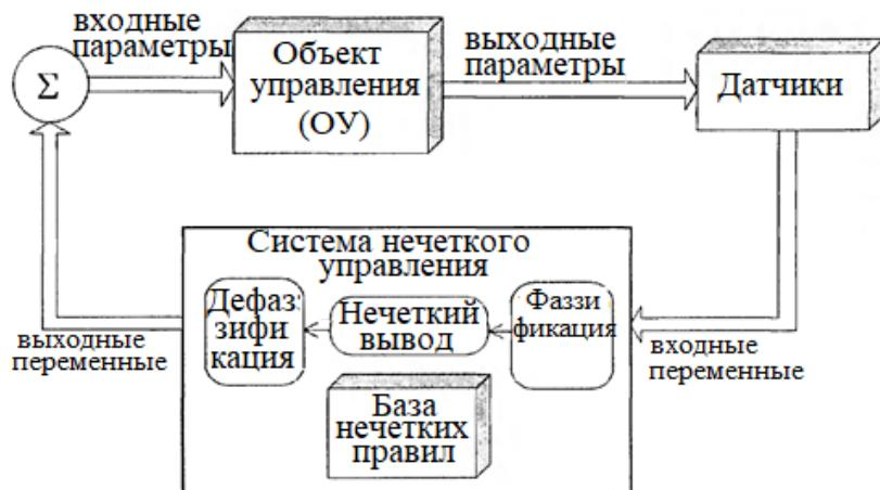
Рис. 2.10. Архитектура компонентов процесса нечеткого управления
