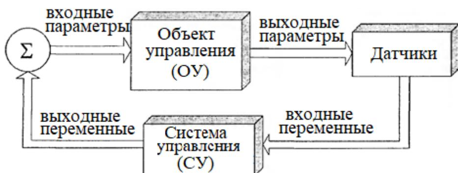
Рис. 2.9. Архитектура компонентов процесса управления с обратной связью
