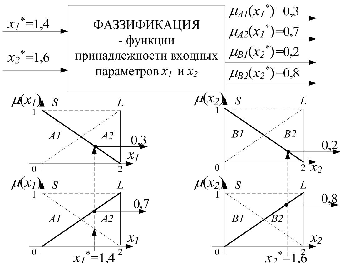
Рис. 2.2. Пример работы блока фазификации
