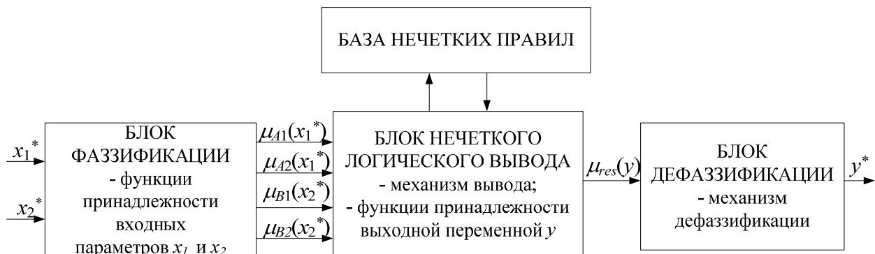
Рис. 2.1. Блочная структура модуля нечеткого управления
